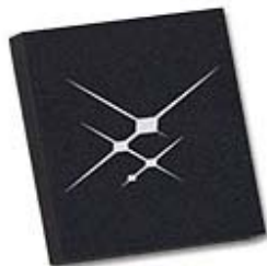
Multichip Module (MCM) 6 x 6 mm
